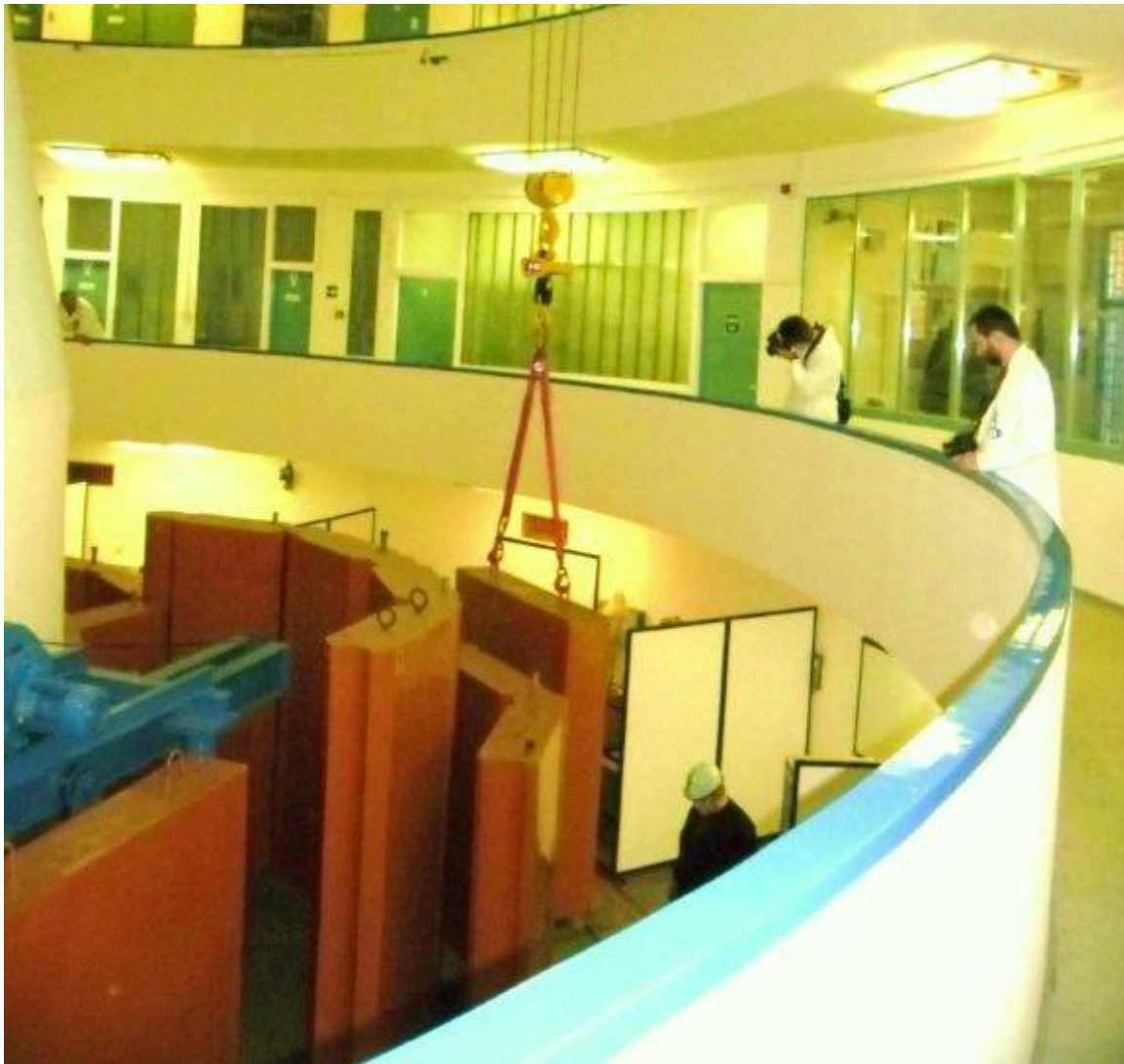
2.3-2. kép: A BME NTI Oktatóreaktor kördaru erőmérési próbájának hatásági ellenőrzése
